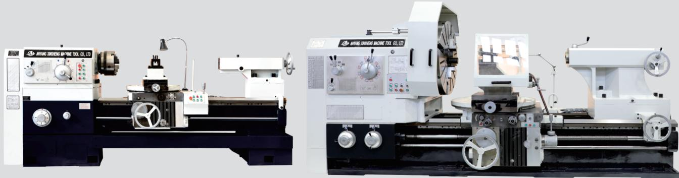
球面车床主要用于球阀之球芯体其外球面的车削加工。加工球面直径在550mm-1800mm。可实现精车、半精车、磨削等加工工作。床身采用矩形导轨，稳定性好，刚性强、主轴采用三支撑结构，刚度高、精度高，可强力切削。用户可根据加工工件大小及用途选择特殊配置或者特殊订货。
